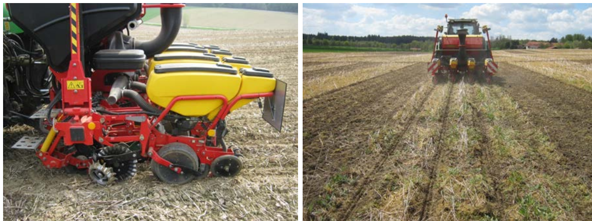
Einzelkornsäugerät mit Vorwerkzeugen (links), Mulchsaat ohne Saatbettbereitung (rechts)
