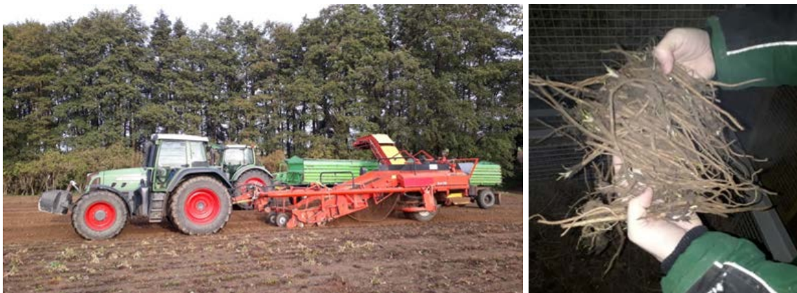
Modifizierte Kartoffelerntemaschine als Versuchsgesät (links) und gereinigte Löwenzahnwurzeln (rechts)
