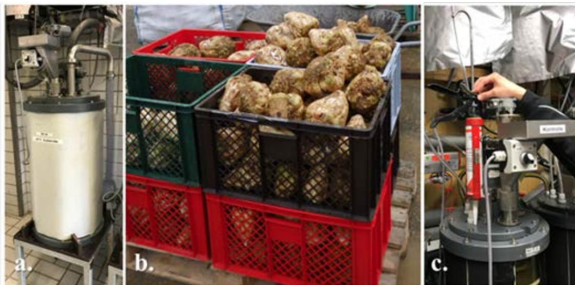
Nachgärerstufe für den Stoßbelastungstest (links), Zuckerrüben vor der Silierung (Mitte), Fütterungssystem für den Stoßbelastungstest (rechts)
