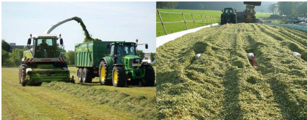
Grasernte mit Online Ertrags- und Feuchtemessung am Feldhäcksler (links)
